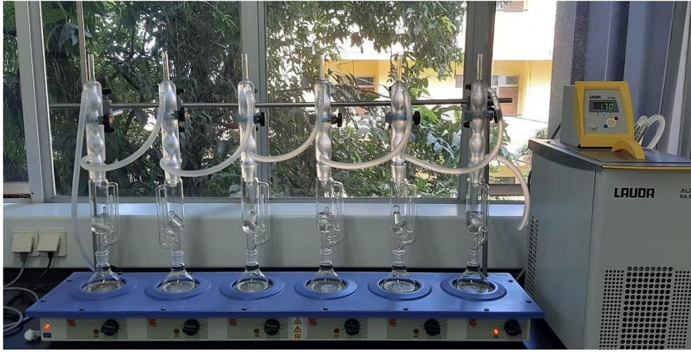
Lampiran 6. Kegiatan Proses Distilasi di Rangkaian Soxhlet untuk Uji Lemak
