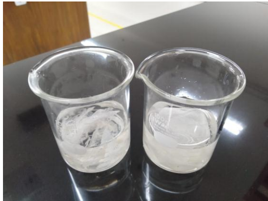
Gambar 32. Sampel yang Telah di Uji Ketahanan Dalam Air
