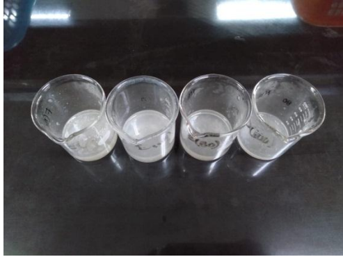
Gambar 35. Sampel yang Telah di Uji Ketahanan Dalam Asam
