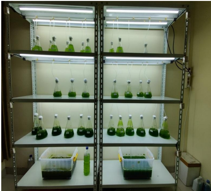
Gambar 7. Rangkaian alat kultivasi mikroalga H. pluvialis di Laboratorium Okeanos Lautkoe
