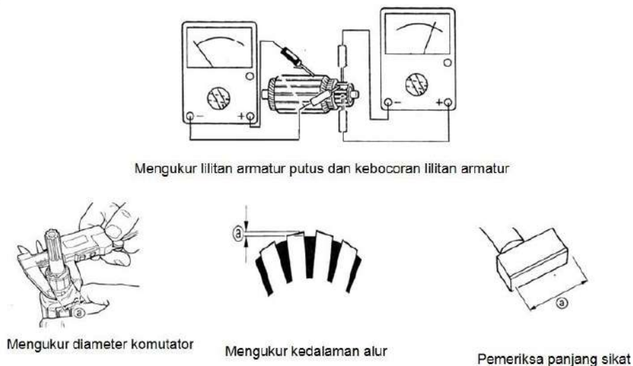
Gambar 2.57. Pemeriksaan motor starter
