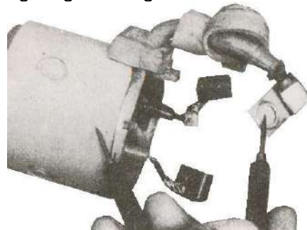
Pemeriksaan kebocoran ke bodi
