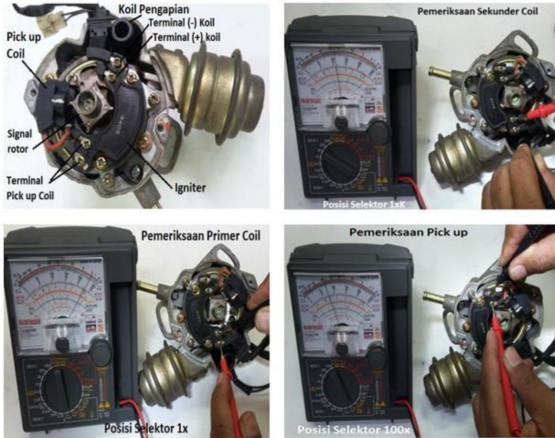
Gambar 13. Pemeriksaan koil pengapian dan pick up coil
