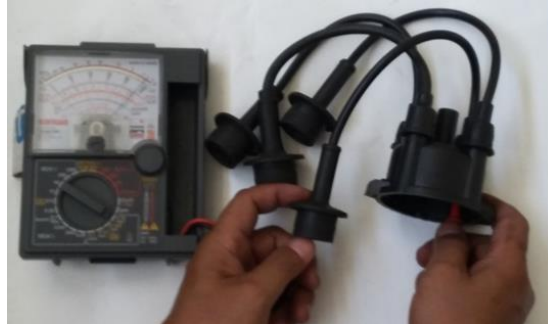
Gambar 5. Memeriksa kabel busi
