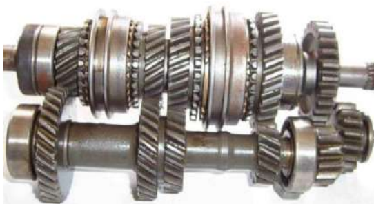
Gb. 1. Susunan Roda gigi transmisi 4 kecepatan
