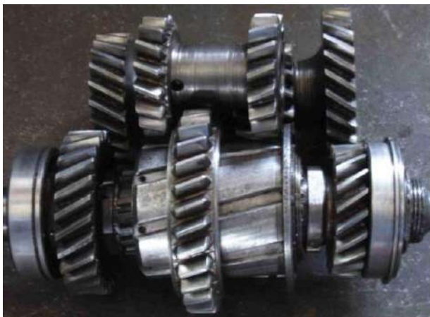
Gb. 1. Susunan roda gigi transmisi 3 kecepatan
