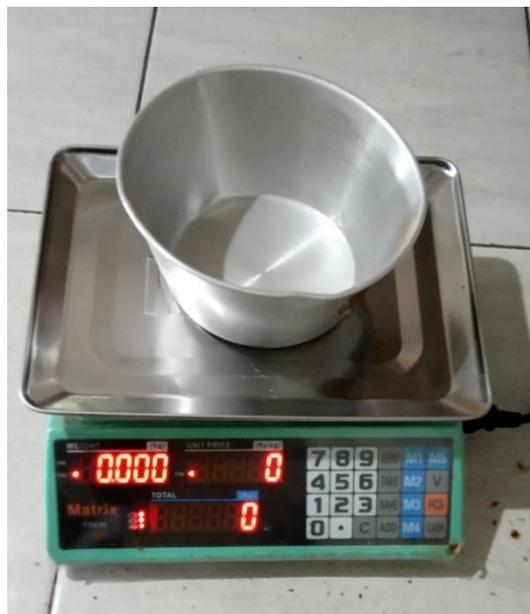
Gambar 1. 39. Timbangan Digital *Scale* 30 kg Ds-11030
