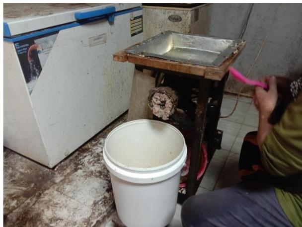
Gambar 1. 32. Mesin Penggiling Bumbu *Stainless Steel* 8 inc Komplit
