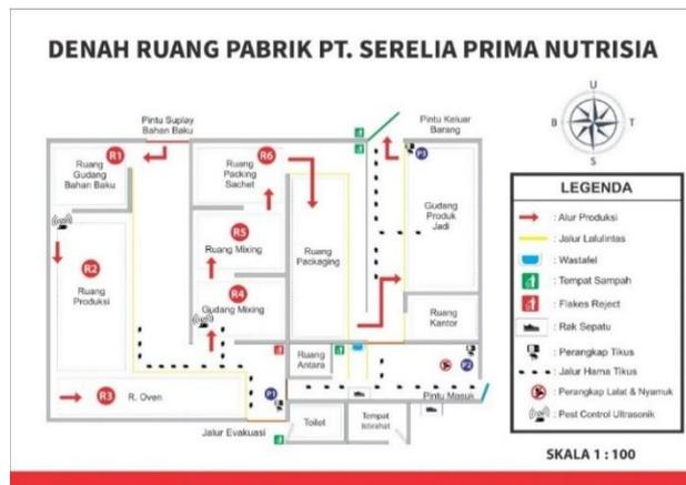
Gambar 1. 45 Denah Tempat Produksi
