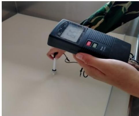
Gambar 1. 12. Pengecekan pH Sumber : Dokumentasi Pribadi (2021)
