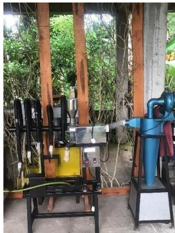
*Gambar 26. Mesin Desheller*
