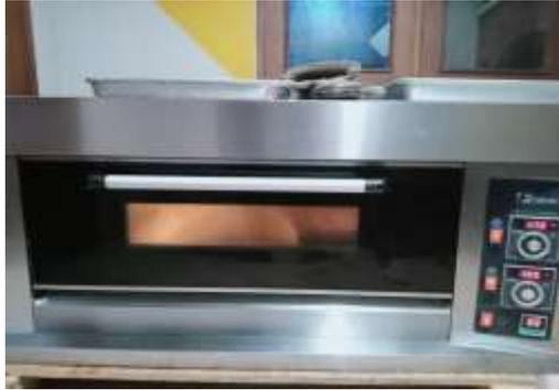
Gambar 1. 30 Proses pengovenan bakpia dengan dengan suhu  $165^{\circ}\text{C}$  selama 30 menit
