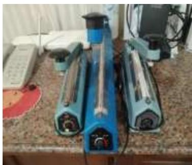
Gambar 1. 36 Mesin sealer yang digunakan untuk mengemas kemasan bakpia
