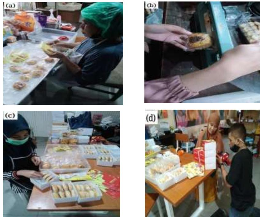
Gambar 1. 32 Proses pengemasan bakpia : (a) pengemasan bakpia kedalam plastik, (b) pengemasan bakpia menggunakan mesin sealer, (c) pengemasan bakpia kedalam dus (d) pelabelan masa *expayer* pada dus bakpia
