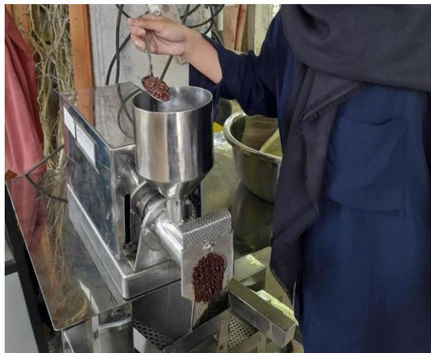
Gambar 1.26 Mesin Pemasta
