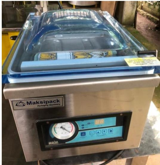
Gambar 1.46 Mesin Pengemas Vakum
