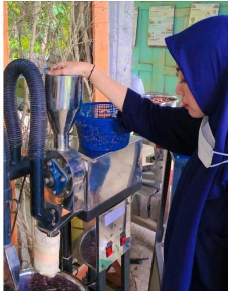
Gambar 1.23 Mesin *Desheller*
