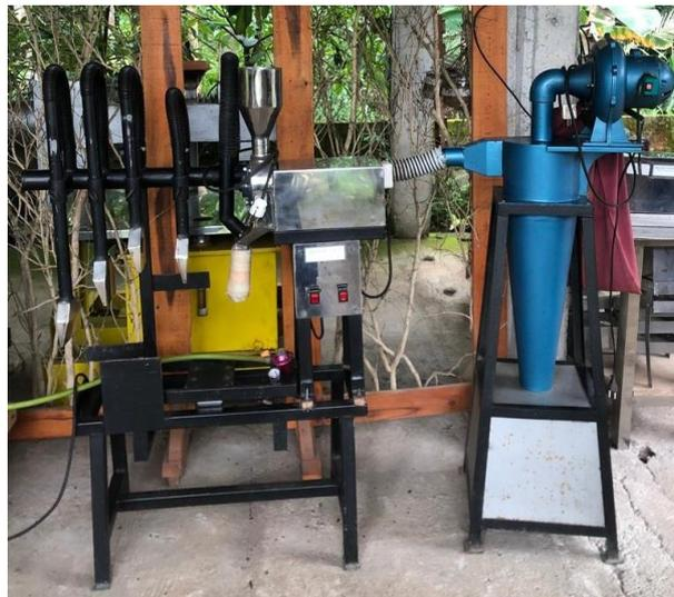
Gambar 1.42 Mesin *Desheller*
