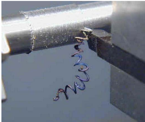
Gambar 3. Pembentukan geram pada proses bubut
