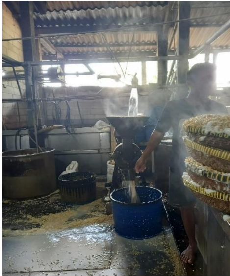
Gambar 1.7. Proses Penggilingan Kedelai
