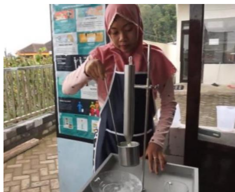
Gambar 1.9 Pengecekan Berat Jenis atau Densitas Susu
