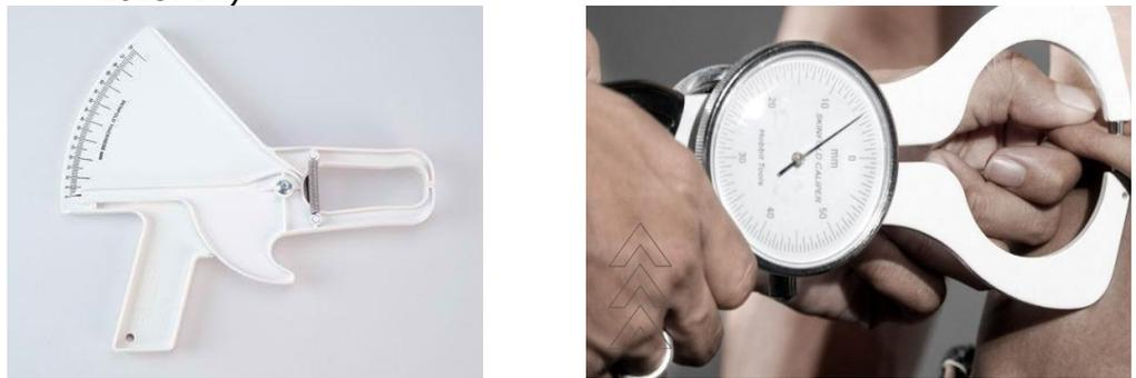
Gambar 3. Kiri. Skinfold caliper manual. Kanan. Skinfold caliper pegas
