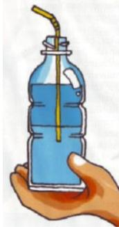
Gambar.1.Desain Thermometer Sederhana
