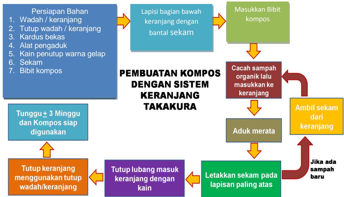
Gambar 13. Langkah – langkah pembuatan keranjang kompos takakura
