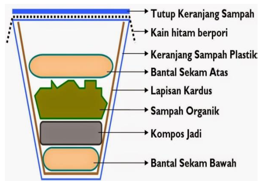
Gambar 12. Susunan Komponen Keranjang Kompos Takakura
