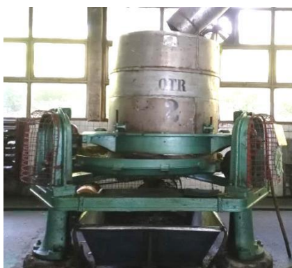
Gambar 1. 17. Open Top Roller
