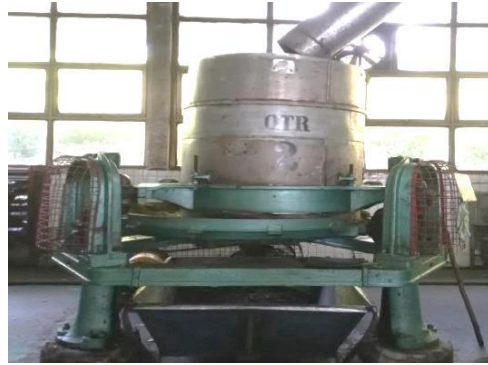
Gambar 1. 8. Proses penggilingan daun teh
