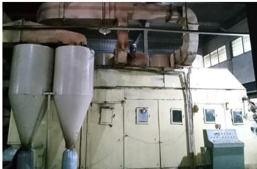
Gambar 1. 11. Proses pengeringan bubuk teh
