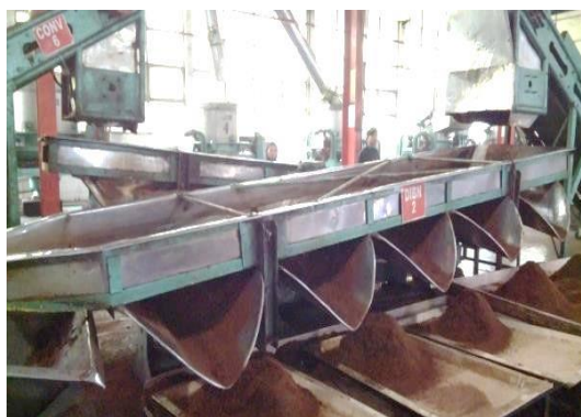
Gambar 1. 19. Double Indian Ball Breaker Natsortir DIBN
