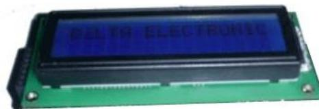
Gambar 2.12 LCD 16x2
