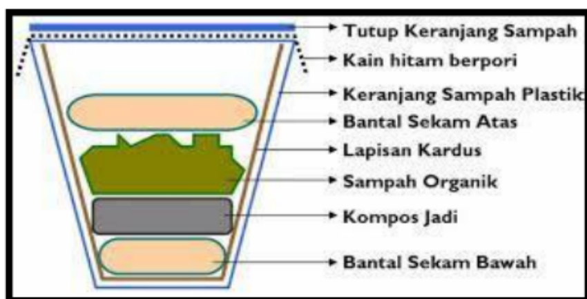
Gambar 2. Susunan Keranjang pada Pengomposan Takakura
