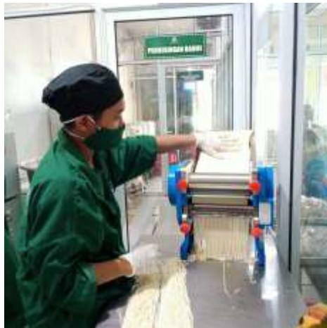
Gambar 1. 17 Proses Pencetakan Mi Basah
