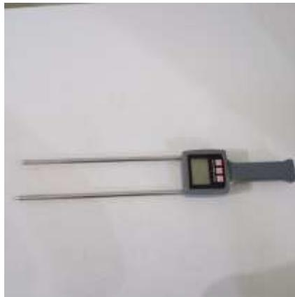
Gambar 1. 38 *Grain Moisture Meter*
