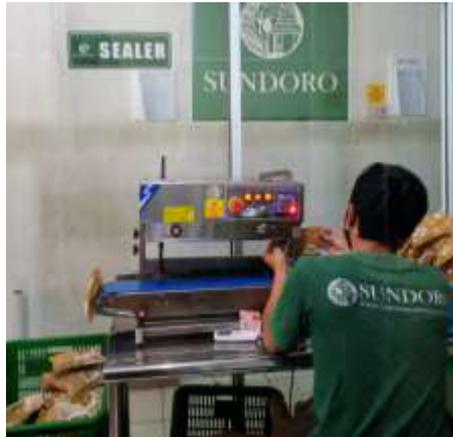
Gambar 1. 24 *Sealing* Kemasan
