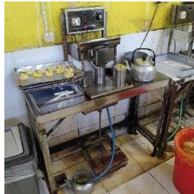
Gambar 1.32 Pengepresan Plastik Seal Ke Cup Kemasan
