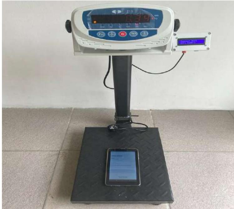
Gambar 6. Produk protitipe alat timbangan bank sampah
