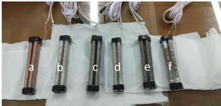
Gambar 3. Sensor suhu kumparan Cu berlapisan Ni. (a) sebelum dilapisi, (b) hasil pelapisan Cu dengan Ni pada suhu elektrolit 30 °C, (c) 40 °C, (d) 50 °C, (e) 60 °C, (f) 70 °C.
