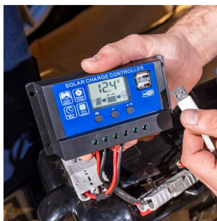
Gambar 4. Solar charge controller 48 Volt.
