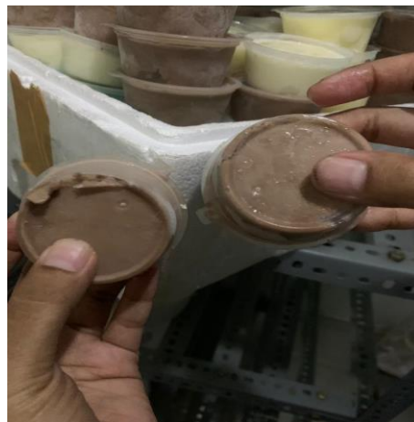
Gambar 2. 2 Kemasan Bocor Sumber: Dokumentasi Pribadi (2022)
