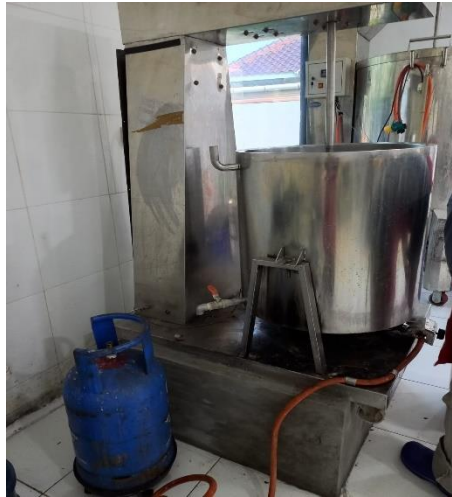
Gambar 1. 30 Mesin Pasteurisasi Sumber: Dokumentasi Pribadi (2022)
