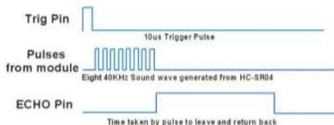
Gambar 5 Diagram Pewaktuan Sensor Ultrasonik HC SR04
