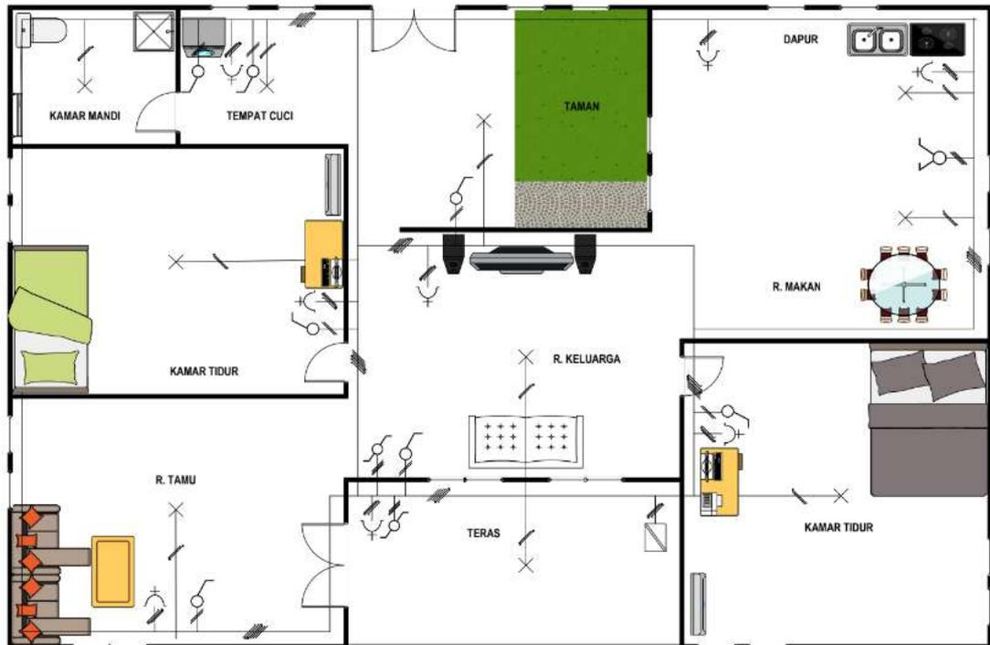
Gambar 30. Single Line Diagram Pada Visio
