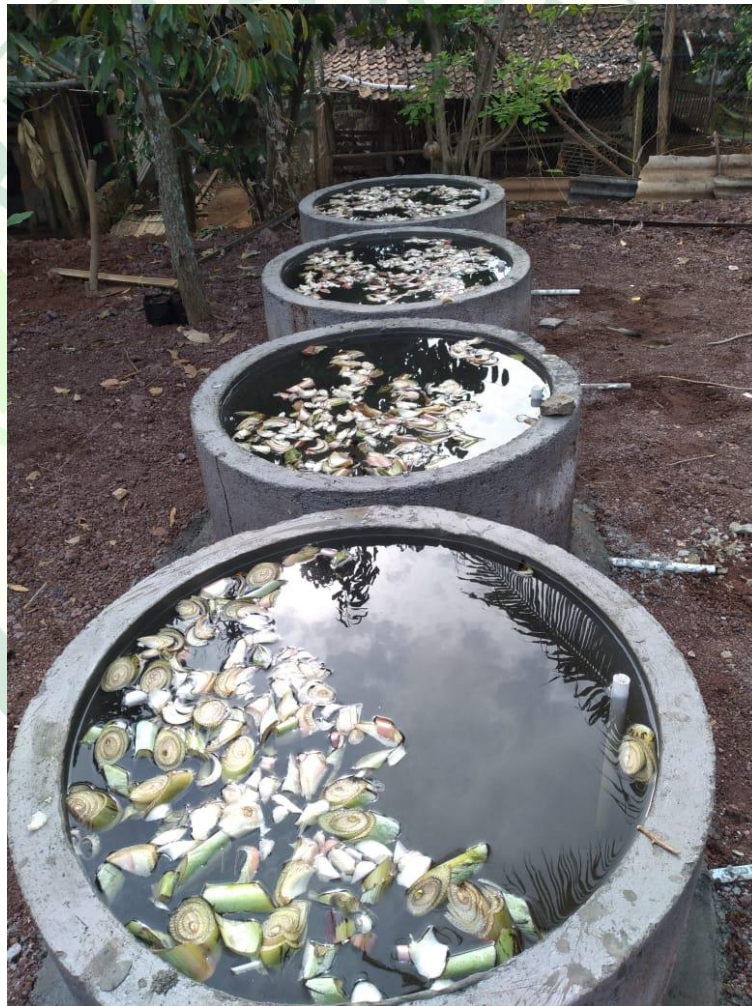
Gambar 4.2. Proses Penghilangan Senyawa Kimia pada Buis Beton
