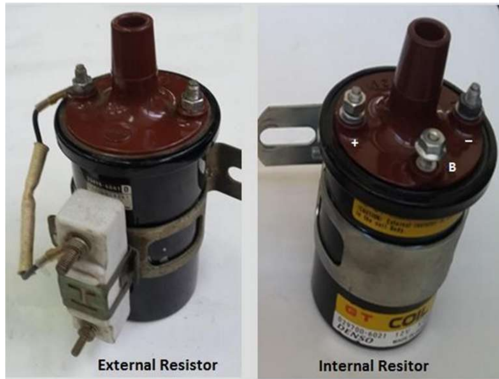
Gambar 1.12 Konstruksi koil pengapian dengan external resistor
