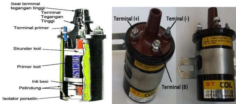
Gambar 1.9 Konstruksi Koil Pengapian
