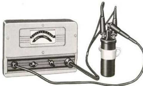
Gambar 1.78. Memeriksa koil menggunakan coil tester
