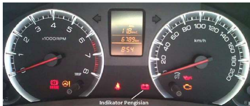
Gambar 3.61. Indikator lampu pengisian pada meter kombinasi
