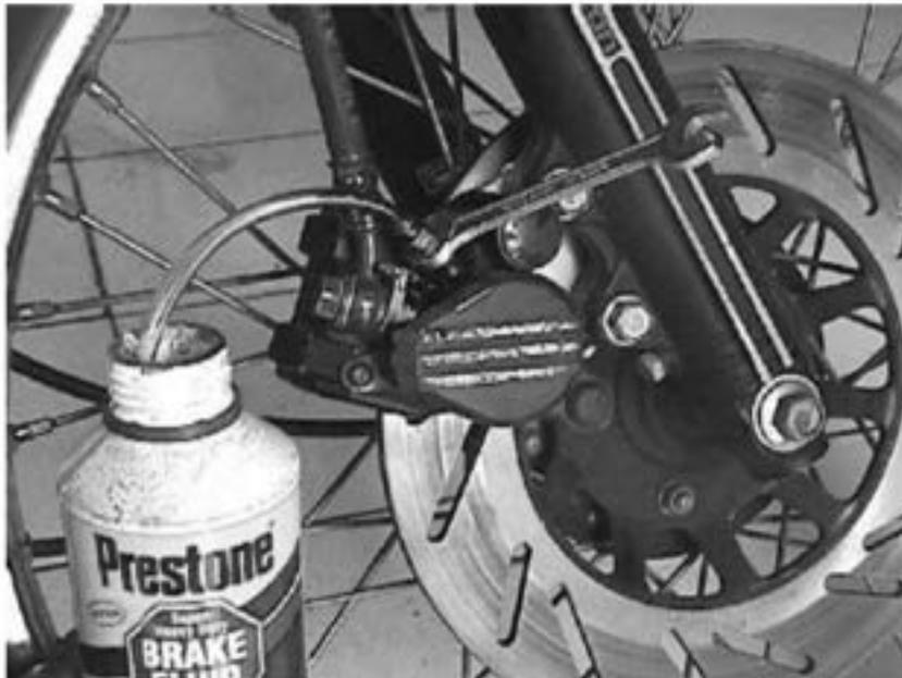
Gambar 23. Mengeluarkan minyak rem
