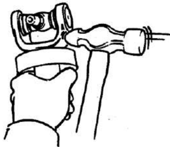
Gb. 12. Menepatkan snap ring (gunakan palu plastik/ nylon)
