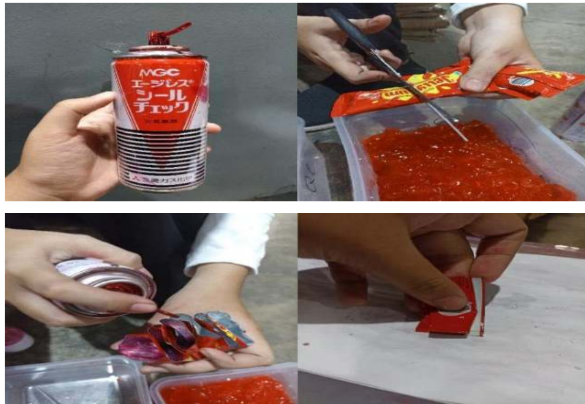
Gambar 1.15 Pengecekan Kebocoran (a) Cairan MGC (b) Pemotongan jelly gum (c) Penambahan cairan MGC (d) Menggosokan kemasan jelly gum ke kertas; Sumber: Dokumentasi Pribadi 2021.
