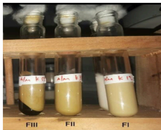
Gambar 13. Hasil uji stabilitas Sediaan: FI. krim A/M ekstrak etanol daun kelor 1%, FII. krim A/M ekstrak etanol daun kelor 3%, FIII. krim A/M ekstrak etanol daun kelor 5%
