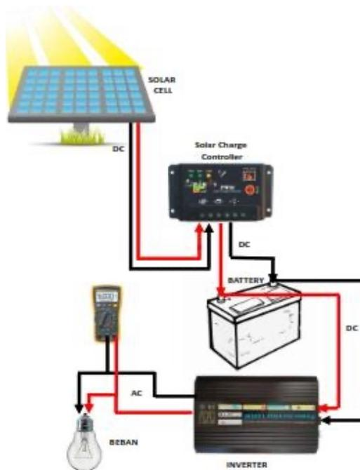
Gambar 9.10 Pengukuran Tegangan Inverter
