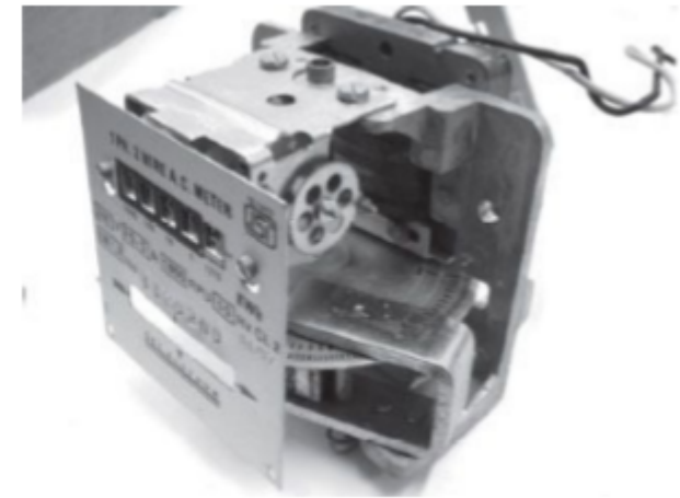
Gambar 7.5 Foto energi meter fase tunggal jenis panggil
