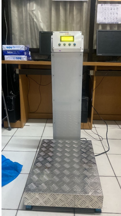
Gambar 1. Timbangan digital yang dibangun dengan teknologi IoT
