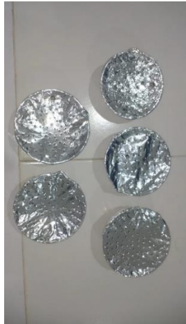
Sebelum dimasukkan ke oven ditutup dengan aluminium foil yang telah dilubangi
