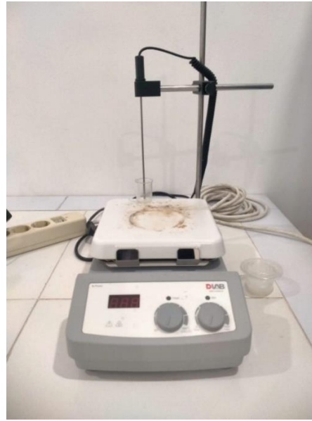
Pemanasan aquadest hingga suhu 60^{\circ}\text{C} dan dilakukan pelarutan
