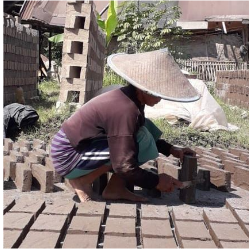
Gambar 1.1 Posisi Pekerja Pada Proses Penjemuran Bata (Samping)
