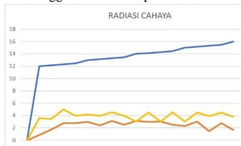
Gambar 3.14 Grafik radiasi cahaya menggunakan pembersih dan tidak menggunakan pembersih
