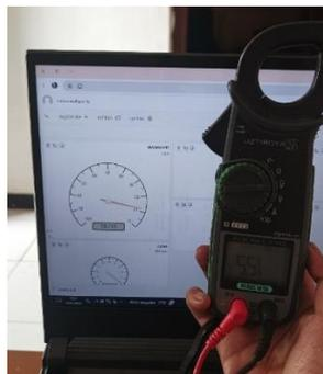
Gambar 3.3 Pengujian sensor tegangan
