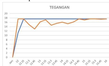
Gambar 3.11 Grafik tegangan menggunakan pembersih dan tidak menggunakan pembersih
