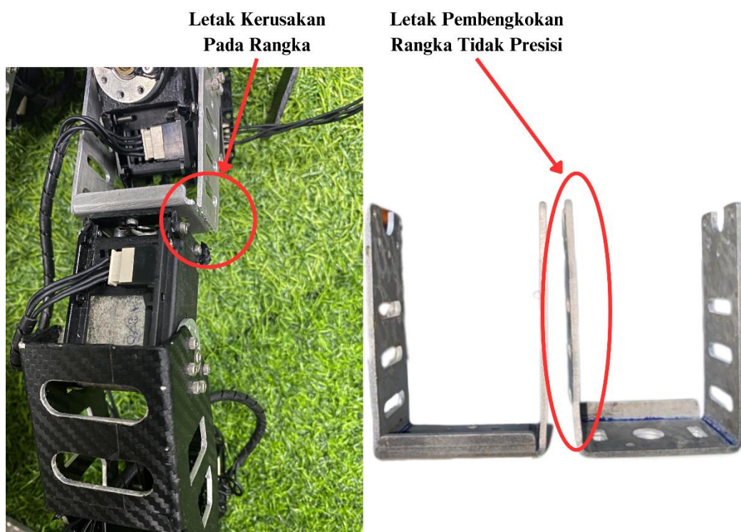
Gambar 1. 3 Desain Frame (rangka) Paha Terjadi Kerusakan.
