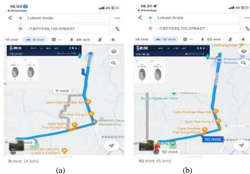
Gambar 3. Pengujian pengiriman data jarak jauh; (a) jarak 4 km, (b) jarak 5 km
