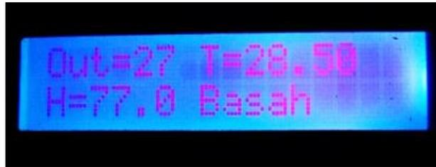
**Gambar 6.** Tampilan LCD Saat Kondisi Jagung Basah
