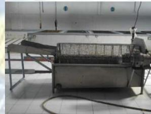
Gambar 8. Mesin *Jet washer*
