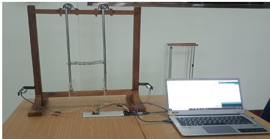
Gambar 1. Alat eksperimen pendulum terkopel dengan Arduino dan sensor ultrasonik
