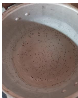
Gambar . Kondisi boiler saat setelah destilasi
