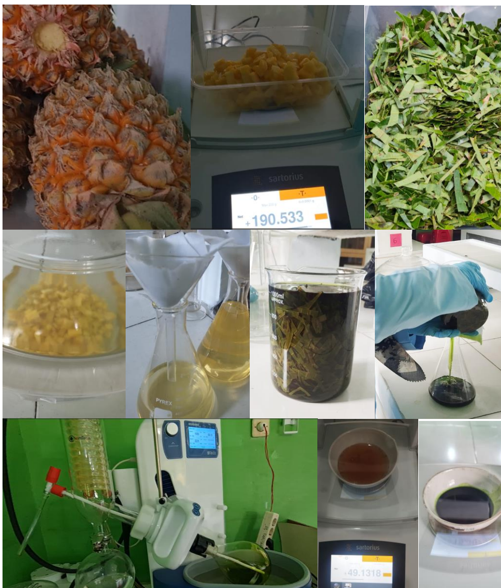
Gambar 1. Atas ki-ka: Buah nanas, bonggol nanas, daun kayu manis. Tengah: Maserasi dan penyaringan bonggol nanas, maserasi dan penyaringan daun kayu manis; Bawah: Ekstraksi dengan rotary evaporator, hasil ekstraksi bonggol nanas dan daun kayu manis
