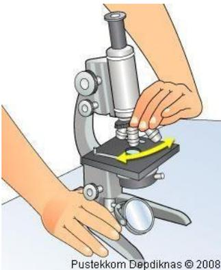
2. Putar revolver sehingga lensa obyektif dengan perbesaran lemah berada pada posisi satu poros dengan lensa okuler yang ditandai bunyi klik pada revolver
