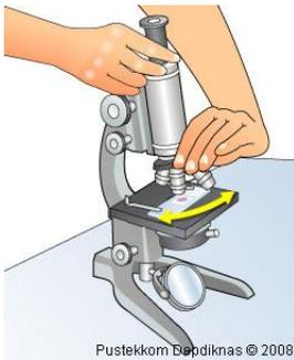
6. Apabila bayangan obyek sudah ditemukan, maka untuk memperbesar gantilah lensa obyektif dengan ukuran dari 10 X, 40 X atau 100 X, dengan cara memutar revolver hingga bunyi klik.
