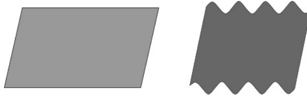
Gambar 1.1: Pembuatan seng gelombang dari plat rata
